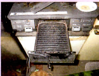
魚グリルの清掃を怠り使用を続けたことにより、油カスが出火した火災
